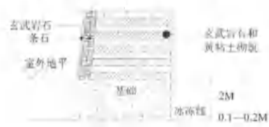
图1 第一宫殿台基、基础做法(作者自绘)
